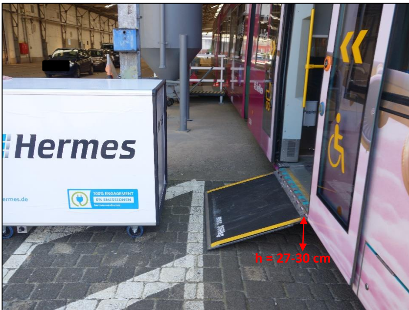
Abbildung 22: Beladung der Tram über integrierte Behindertenrampe 110
